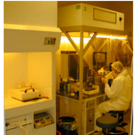
Ligne de fabrication sous flux en salle propre inactinique
